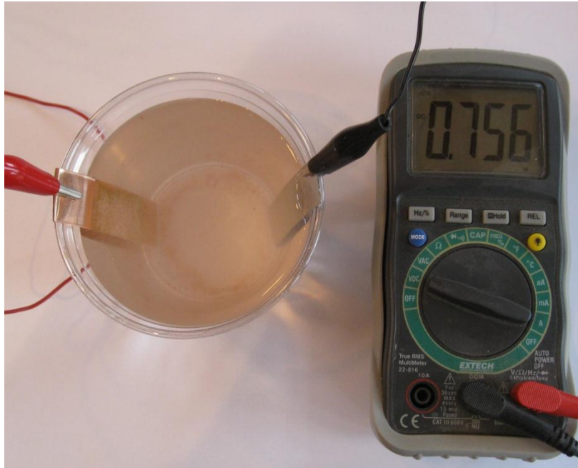
Resim 25: Tuzlu su, bakır ve alüminyum pili
