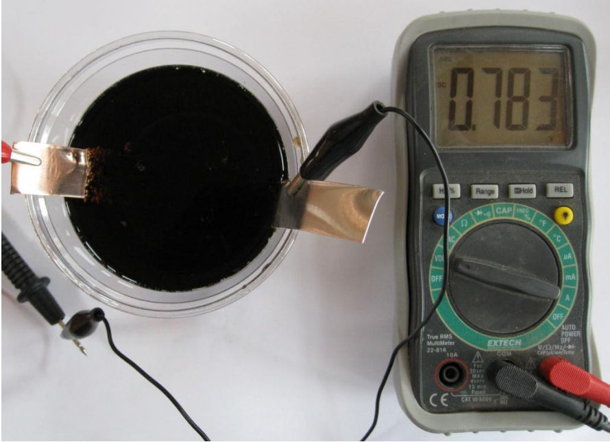
Resim 23: Kola, bakır ve alüminyum pili
