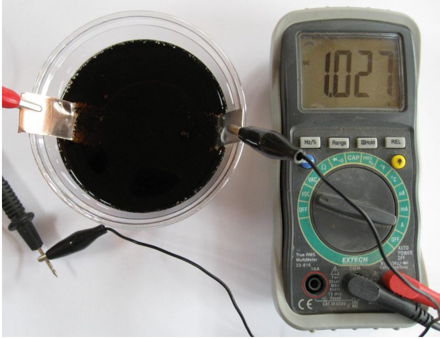
Resim 24: Kola, bakır ve çinko pili
