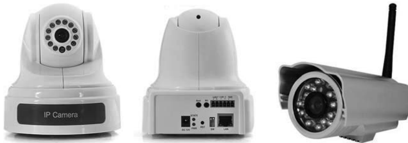
Resim 5.14: Bir kablolu IP kamerası ön ve arka yüzü, bir kablosuz IP kamerası örneği.
