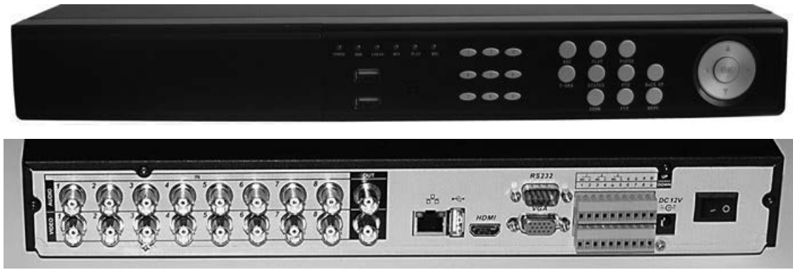
Resim 5.17: Sekiz kamera/ses girişi olan bir DVR cihazı ön ve arka yüzü.
