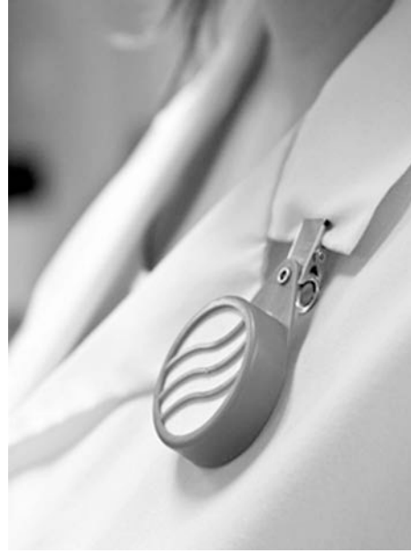
Resim 4.6: TLD tipi dozimetre (sol) ve yakada kullanılan film tipi dozimetre (sağ).
