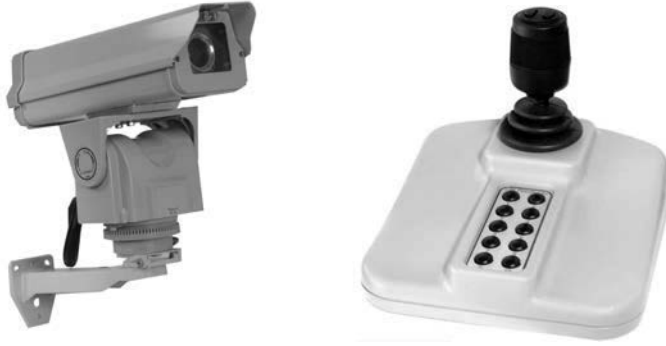
Resim 5.13: Bir PTZ kamera ve PTZ kamera kontrol-kumanda cihazı örneği.
