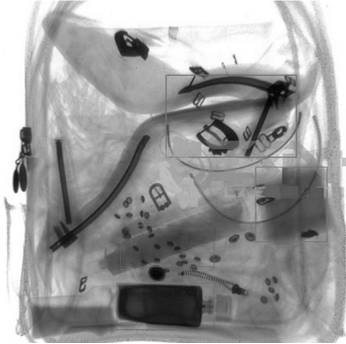
Resim 4.3: Gelişmiş X-Işını cihazı içerisinde şüpheli nesneleri işaretlenmiş çanta görüntüsü.
