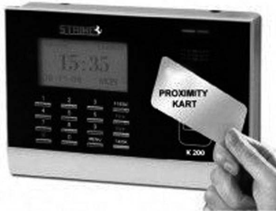
Resim 3.4: Öncelikli (Proximity) Kart ve Kartlı Sistem Örneği
